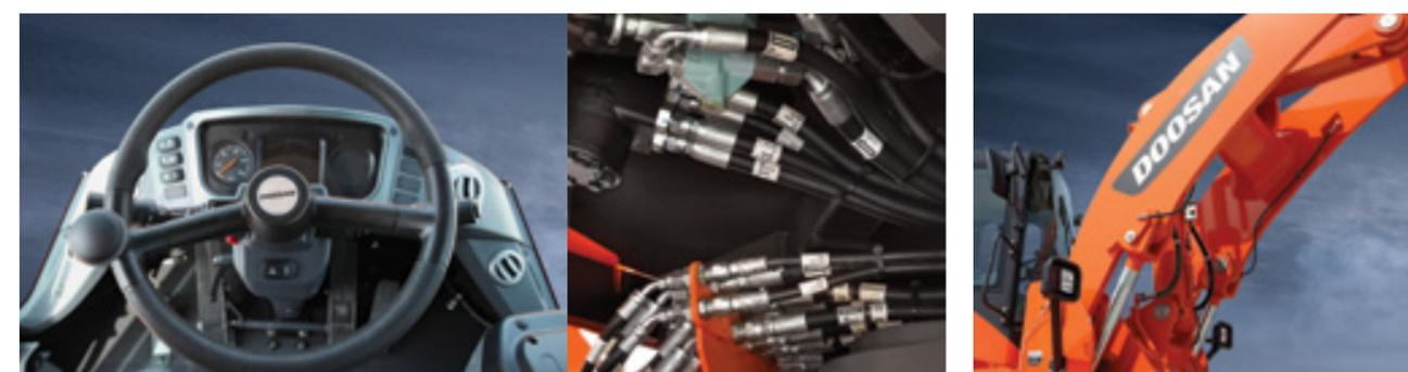
**Рулевое управление с гидравлическим усилителем**
